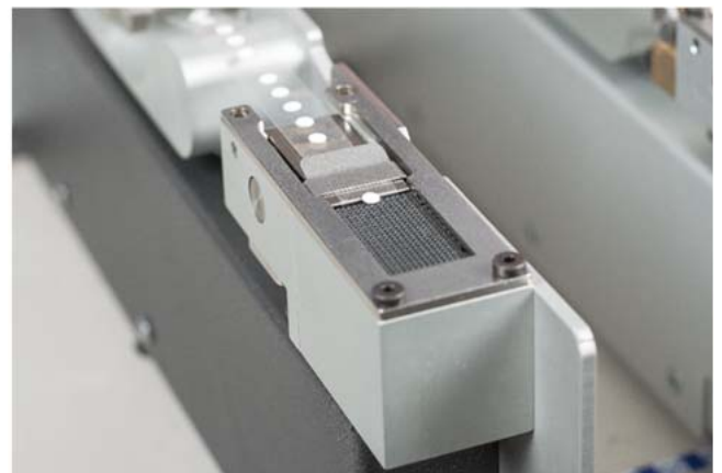
Zuführung eines Sensors von 3 mm Durchmesser
