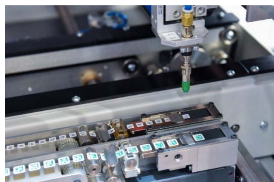
Kennzeichnung per Labelzelle mit zwei Label Feedern
