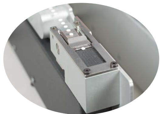
Zuführung eines runden Sensors, 3 mm Durchmesser
