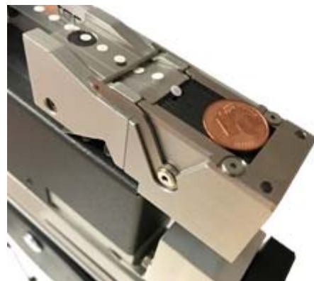
Zuführung eines runden Druckausgleichselements (DAE), 2 mm Durchmesser
